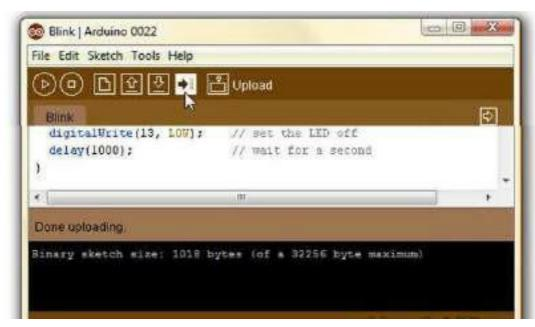
Fig. 2.9.10: Uploading a code
