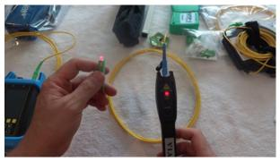
Fig. 5.3.5: Using a Visual Fault Locator (VFL)
